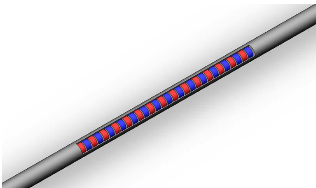
圖 3-3 管型線性馬達定子透視圖
