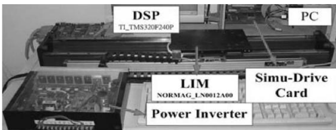
圖 1-1 適應逆推控制器線性磁感馬達定位平台
